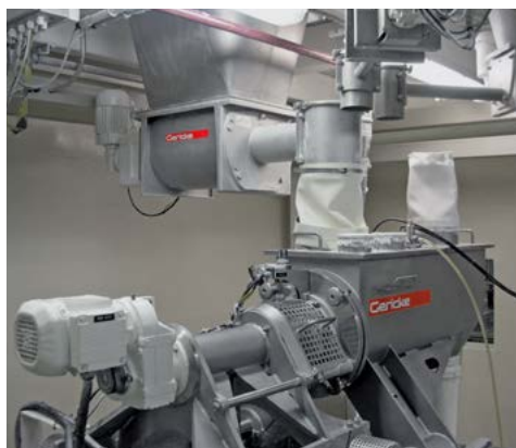
连续混合系统
