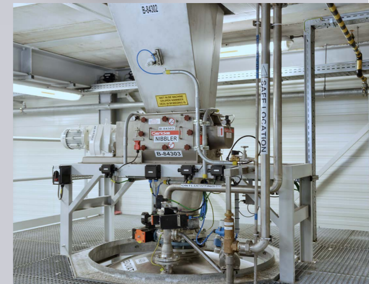
Kalibrierung des Rohmaterials vor dem Reaktor.
