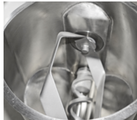
Cámara de alimentación con rompebóvedas
