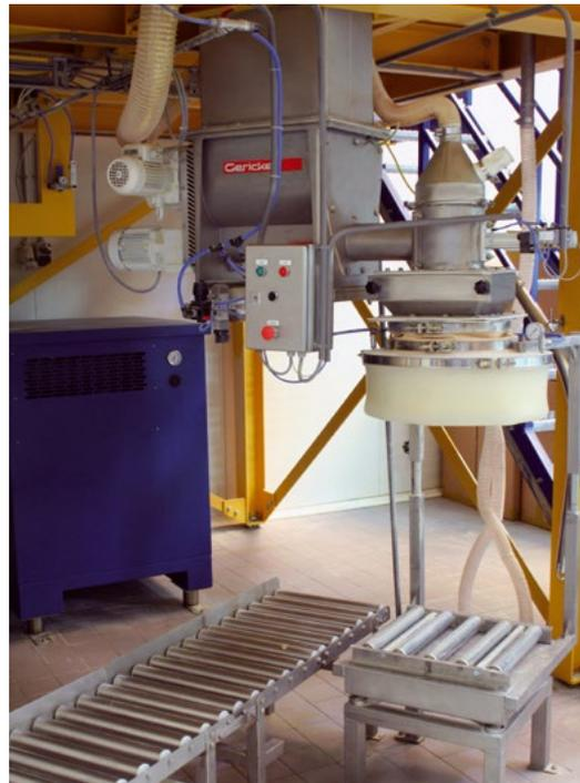
Doseur type GDU 451 équipé d'un système de pesage et d'une table à rouleau pour conditionnement du produit.
