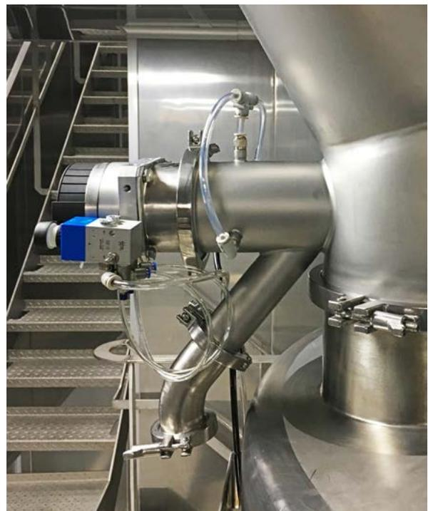
A válvula de amostragem permite que o operador retire uma amostra do produto da linha de produção ou do reator, e a armazene com segurança para ser transportada ao laboratório onde será analisada ou para a sala de arquivo de onde pode ser retirada para uso futuro. A válvula de amostragem da Gericke foi projetada de acordo com as normas mais recentes de construção e incorporou regras de segurança.
