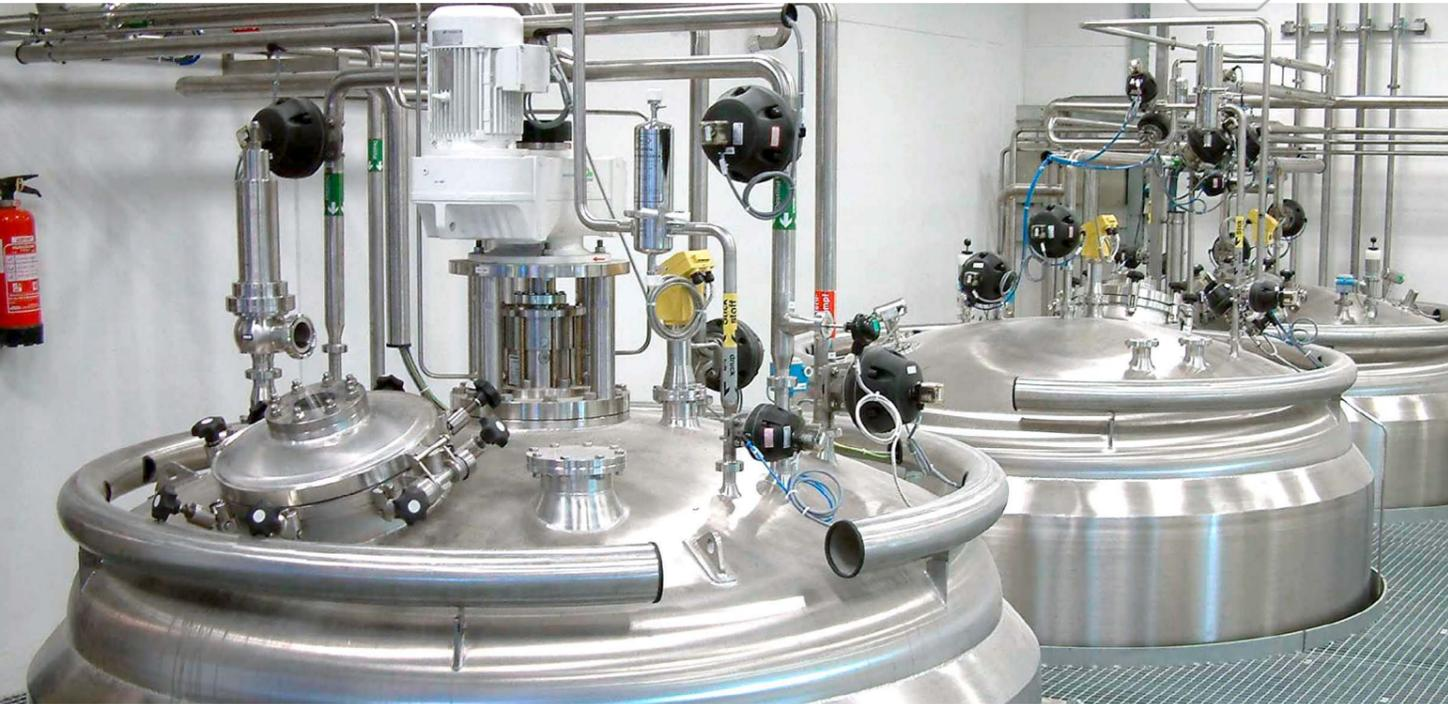
Die Dispergierung bzw. das Lösen von Produkten wird durch die direkte Förderung in den Rührwerksbehälter sogar verbessert, während zusätzliche Vorlagebehälter, Ventile und andere Anlagenteile entfallen können.
