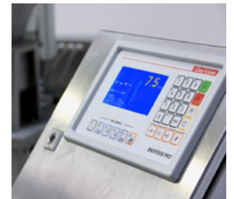
Integrierte Steuerung von Wäge- und Dosierprozessen
