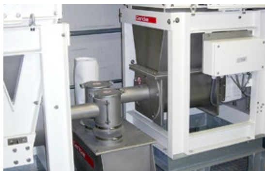
Sistema de mistura contínua
