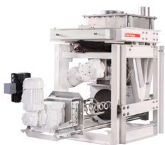
Sistemas de dosagem gravimétrica
